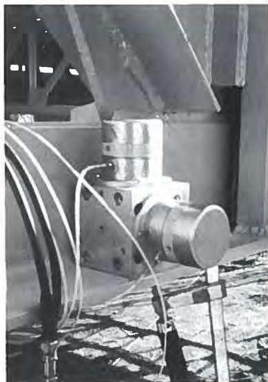
Grafico 4. Mostra il segnale di acquisizione su sei canali. Foto 3. Coppia di accelerometri.
