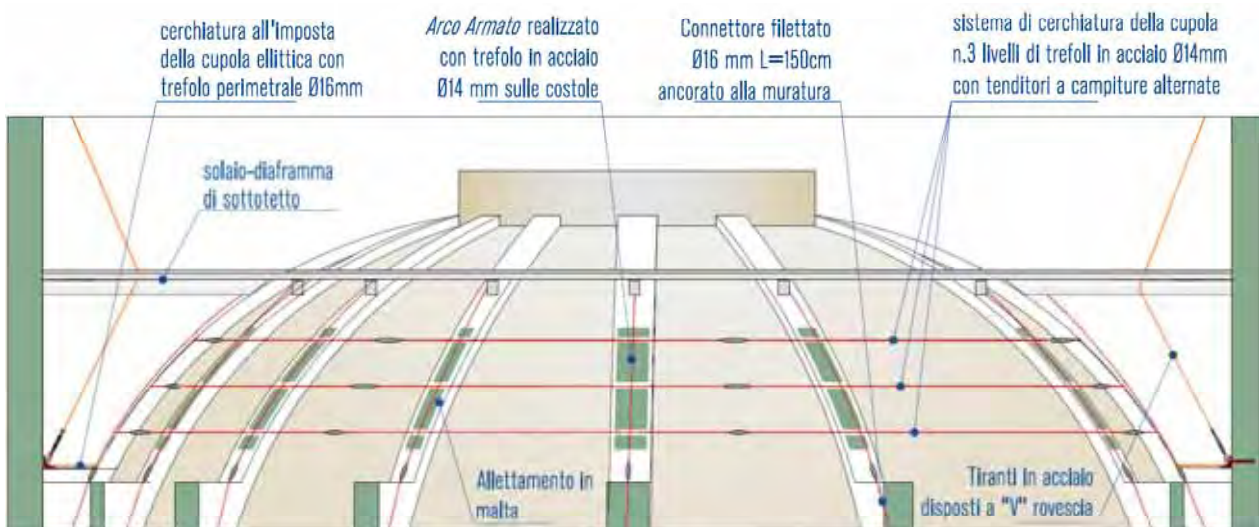
Dettaglio della cerchiatura della cupola della Chiesa di Santa Caterina in Lucca con trefoli disposti secondo meridiani e paralleli, ancorati alla muratura con barre inghisate
