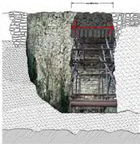
DETTAGLIO DI REALIZZAZIONE DELLA CATENA UNGHIAIA DI RINFORZO TRASVERSALE SEZIONE TRASVERSALE - SCALA 1:50
