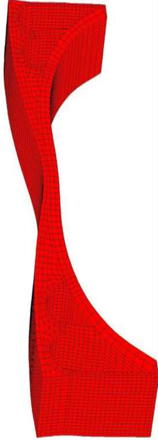
Vista assonometrica del II modo di vibrare, f_2 = 16,6 \text{ Hz}
