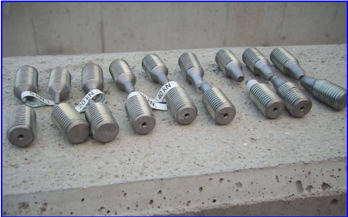
Provini calibrati per i tiri verticali dopo la rottura
