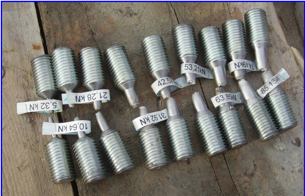
Provini calibrati per i tiri obliqui dopo la rottura
