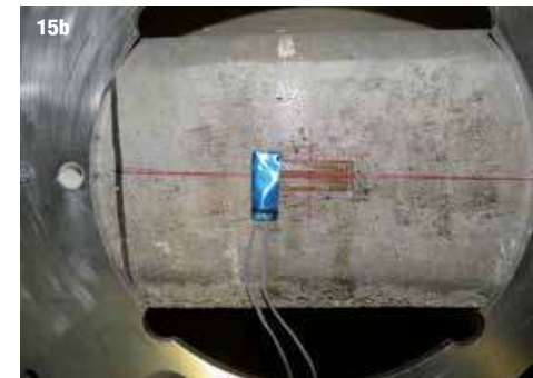
15. Fasi esecutive di una prova di rilascio con provino tronco piramidale
