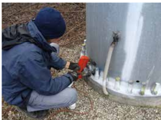
Controllo magnetoscopico alla base
