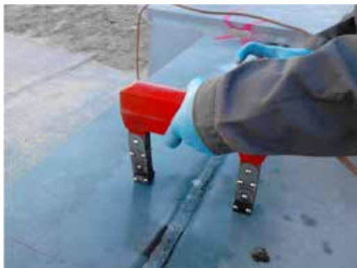
Controllo magnetoscopico con giogo
