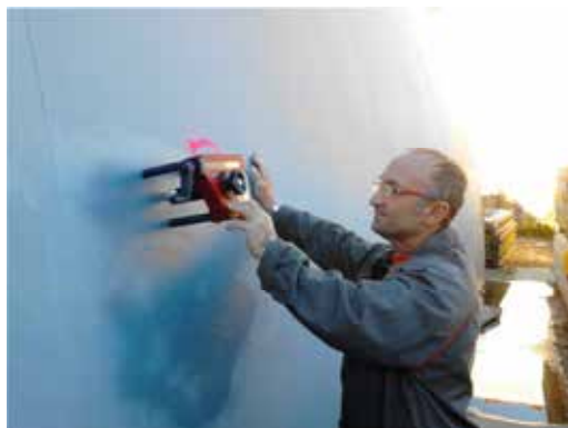
Distacco dei provini e misura della forza
