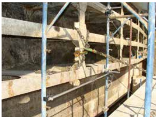
Prova di carico a tiro con martinetto oleodinamico e misura delle deformazioni
