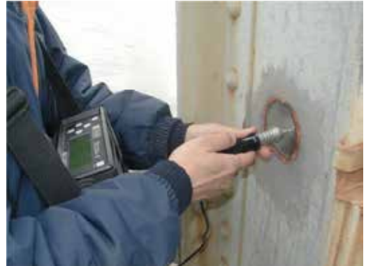
Misure con microduremetro portatile su un ponte ferroviario
