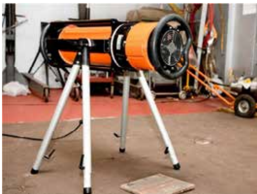
Strumentazioni controlli RT
