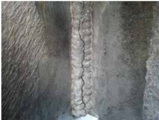
Cricche longitudinali su cordoni di saldatura
