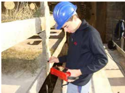
Misurazione spessori con UT
