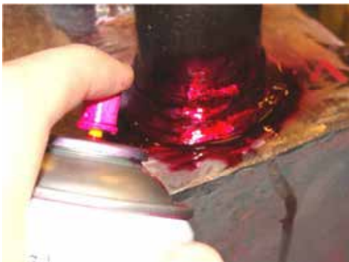
Applicazione del liquido penetrante
