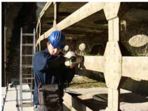
Misura della durezza con durometro portatile
