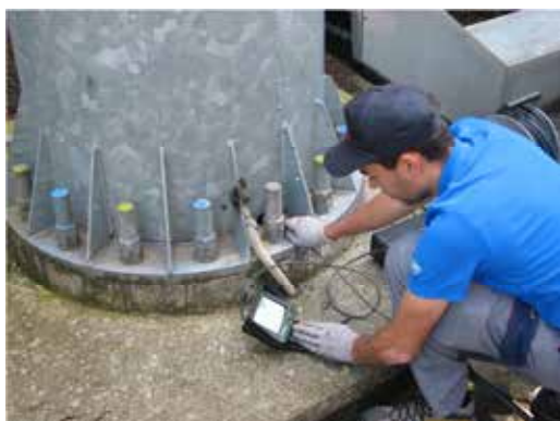
Controllo saldatura interna alla base di un palo porta antenna
