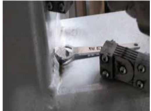
Verifica direzioni di magnetizzazione
