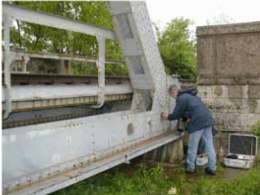
Misure con microduremetro portatile su un ponte ferroviario
