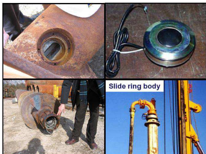
Fig. 5.5.4 – Sensore per la pressione del calcestruzzo
