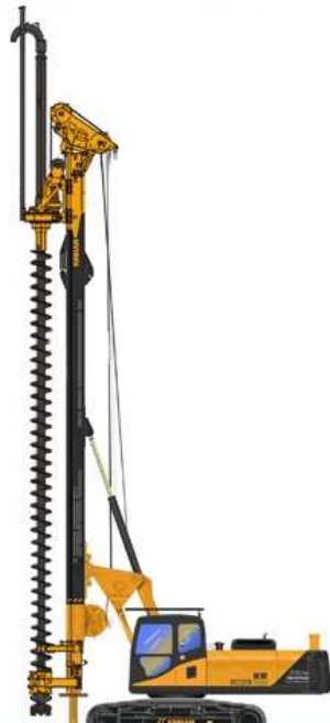
Fig. 5.2.3 – Schema perforatrice idraulica con Kelly bar
