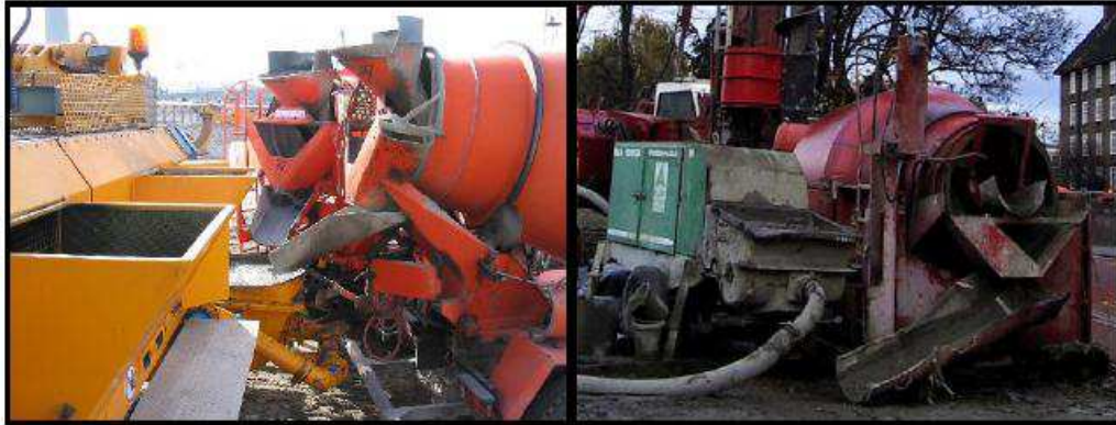
Fig. 5.5.2 - Pompa per il calcestruzzo montata nell'impianto e botte rotante
