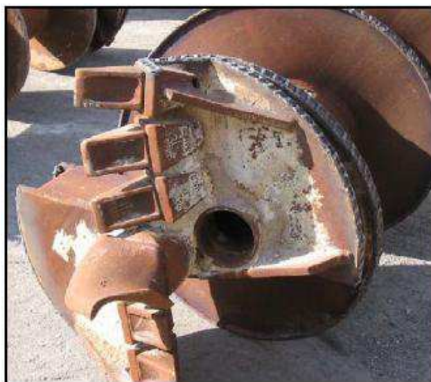
Fig. 5.4.1 – Foro alla base dell'elica per la fuoriuscita del calcestruzzo
