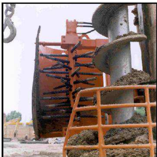
Fig. 5.3.2 – Elica con una grande distanza tra le spire, per terreni argillosi
