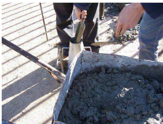
Fig. 5.7.1.2.2 - Riempimento del cono di Abrams
