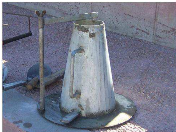
Fig. 5.7.1.2.1 – Cono di Abrams
