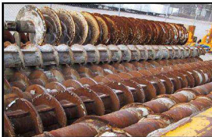
Fig. 5.3.1 – Diversi tipi di eliche in relazioni alle condizioni del terreno
