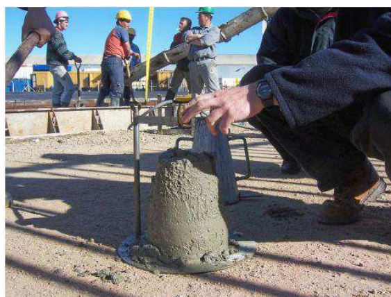
Fig. 5.7.1.2.3 – Sollevamento del cono di Abrams
