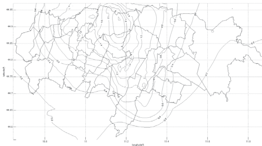
Figura 8: Curve di livello del coefficiente moltiplicativo \alpha(lon, lat) dello spettro di riferimento della norma italiana.
