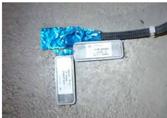
Fig. 5 Coppia di estensimetri protetti da piastra inox.
