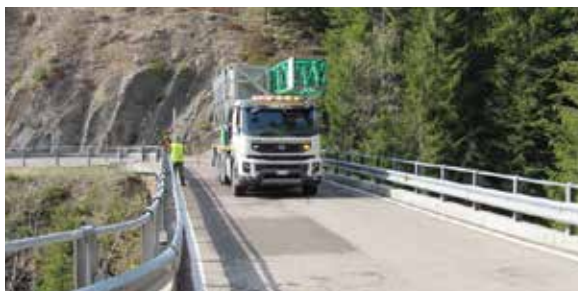
Fig. 9, 10 Carico di misura freccia - deformazione.
