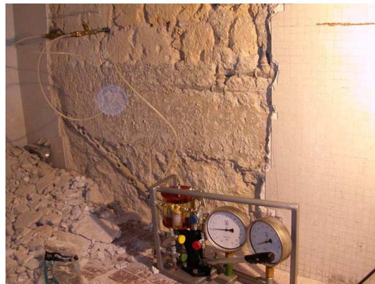
5. Pompaggio di olio in pressione nel martinetto piatto, fino a ristabilire la distanza iniziale tra i riferimenti.
