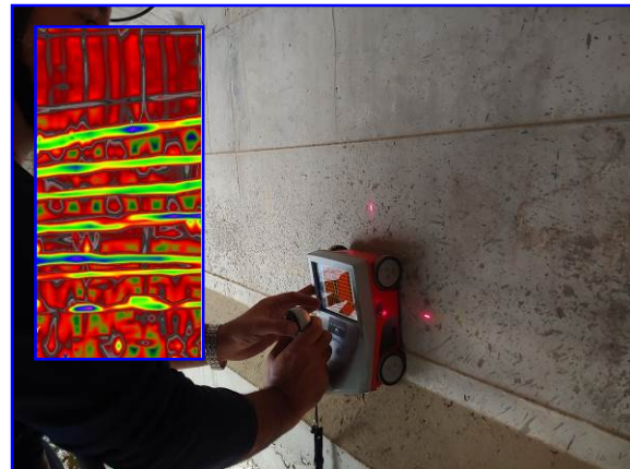
Figura 8: georadar per la ricerca dei cavi nel c.a.p.
