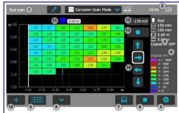
Figura 7: esempio di una corrosion scan
