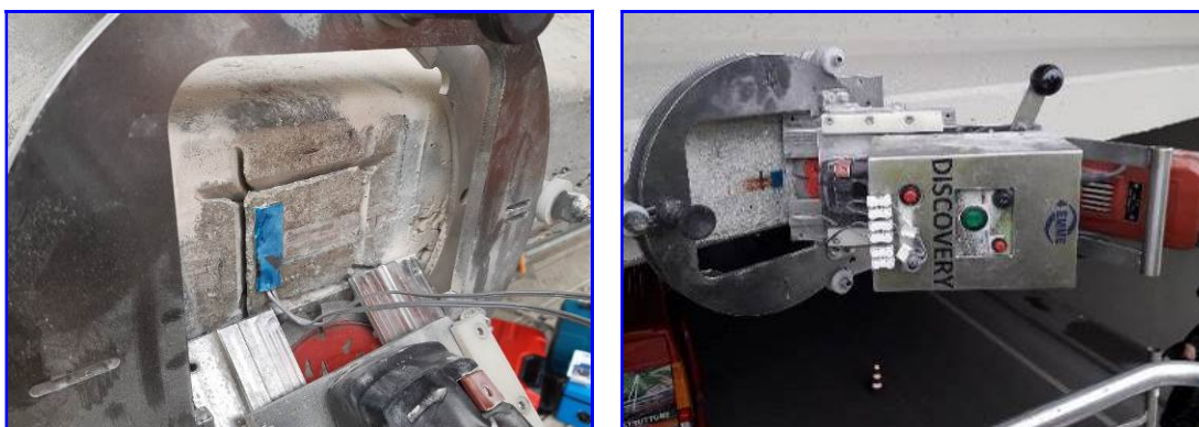
Figura 12: Discovery su trave in c.a.p.
