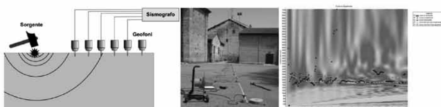
Figura 14: Schema di funzionamento della prova MASW e curva di dispersione delle velocità di propagazione ottenute.
