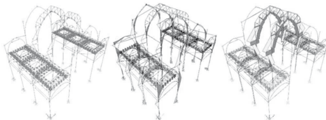
Figura 6: Modello di calcolo del Duomo e delle travi reticolari di consolidamento.
