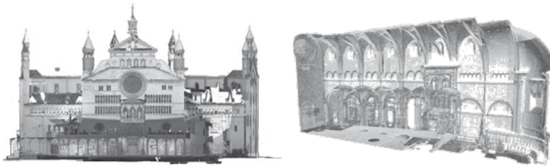
Figura 1: Restituzione di alcune viste tridimensionali con rilievo laser-scanner.
