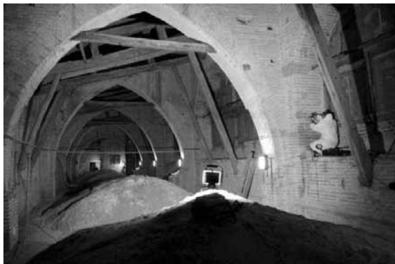
Figura 2: Esecuzione della prova con martinetto piatto singolo nei matronei.
