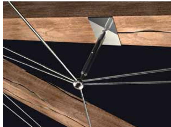
Figura 12 a,b,c. Proposta progettuale di consolidamento della copertura, consistente nella realizzazione di una struttura reticolare tridimensionale costituita da tiranti di piccolo diametro nella parte inferiore della copertura, forzati a sostegno dei puntoni mediante aste telescopiche.
