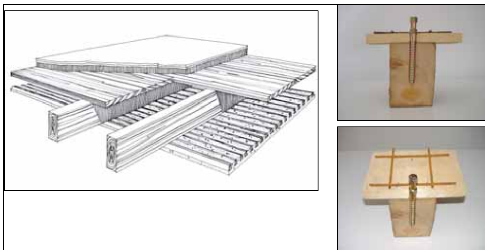
Figura II. 40. La soluzione mista calcestruzzo-legno, con connettori a secco in alluminio filettato
