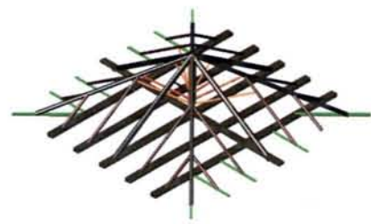
4 - Orditura principale costituita dalle due capriate ortogonali e dai falsi puntoni.
