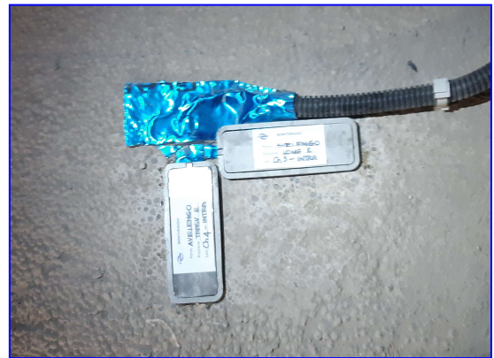
Fig. 5 Coppia di estensimetri protetti da piastra inox
