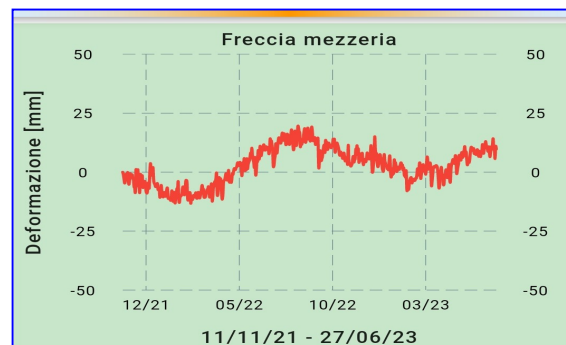
Fig. 9 Andamento della freccia in mezzeria
