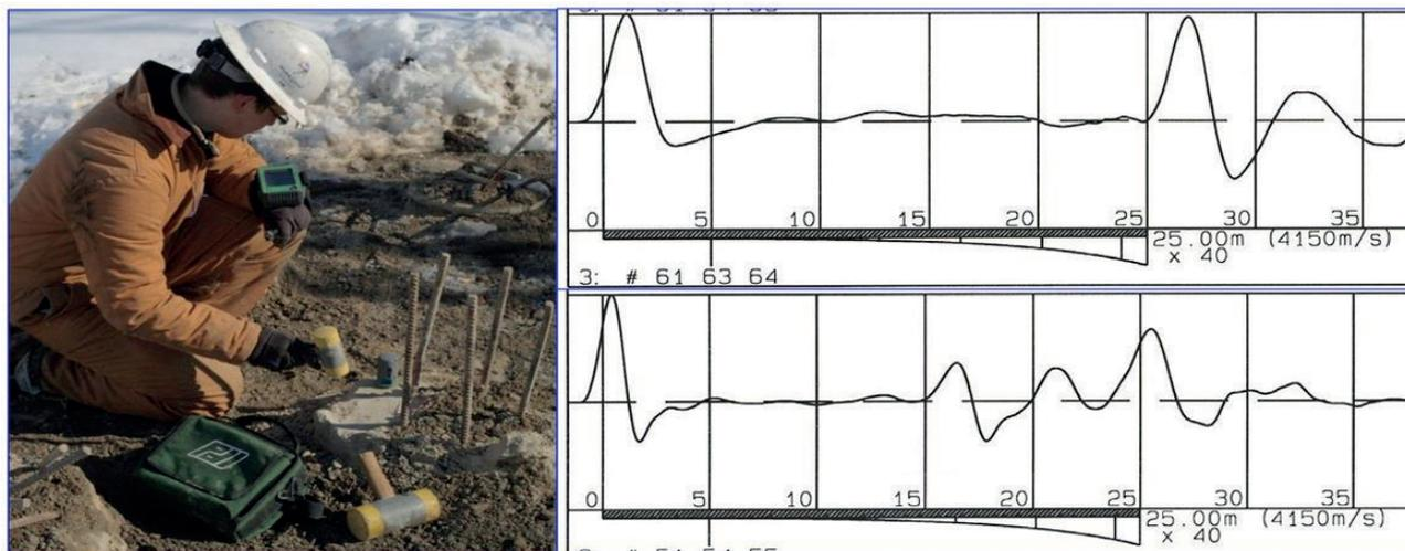
Fig. 11 – Prova PIT. Esecuzione di una prova (sinistra); risultati di due prove (destra); assenza di difetti (sopra) e diminuzione di impedenza (sotto).
