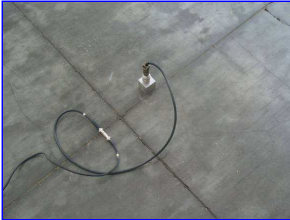
Sensori accelerometrici Z 1 e Z 2
