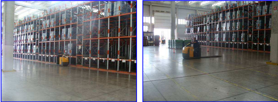
Passaggio commissionatore longitudinalmente alle travi e ortogonalmente, prova 868/AA
