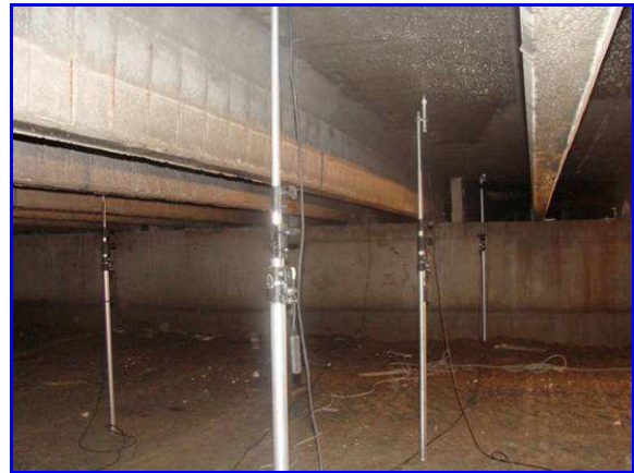
Disposizione sensori all'intradosso del solaio
