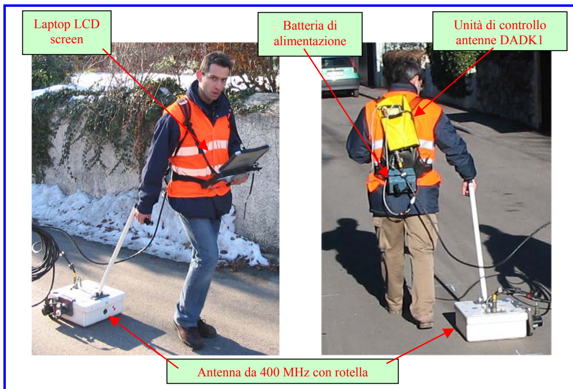
Fig. 4: configurazione del "Sistema georadar RISK20"
