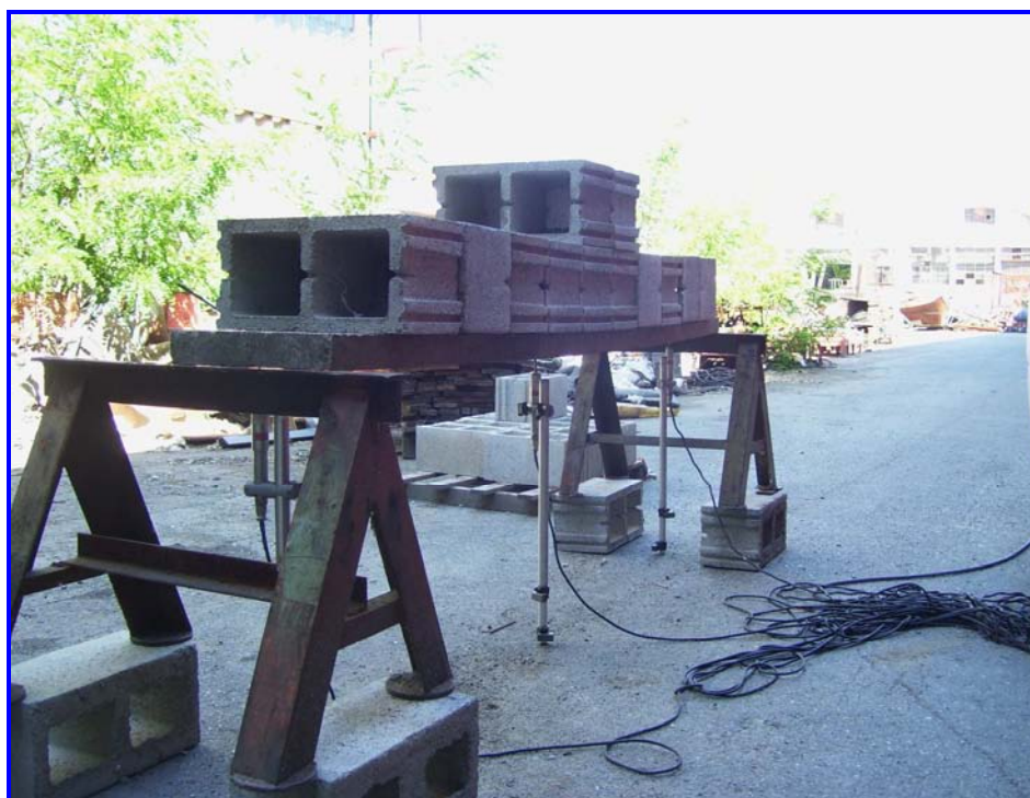
La coppella con i 12 blocchi di cls
