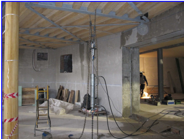
Foto 7: Martinetto oleodinamico per l'applicazione del carico concentrato
