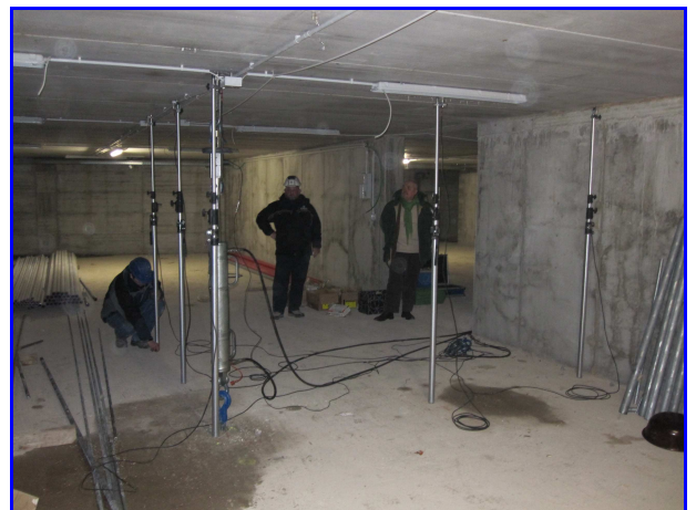
Foto 2: Martinetto oleodinamico e sensori per rilevare le deformazioni in tempo reale
