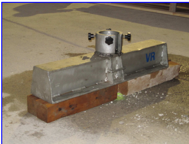
Foto 1: Base di 1,00 m posizionata al piano terra per ripartire il carico sul solaio
