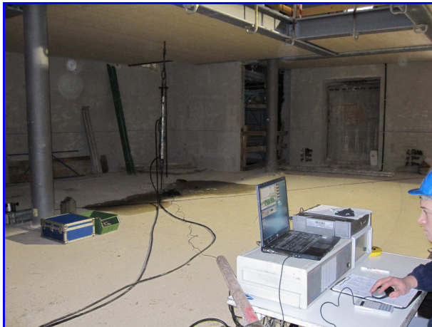
Foto 5: Martinetto oleodinamico e postazione per l'acquisizione dei dati
