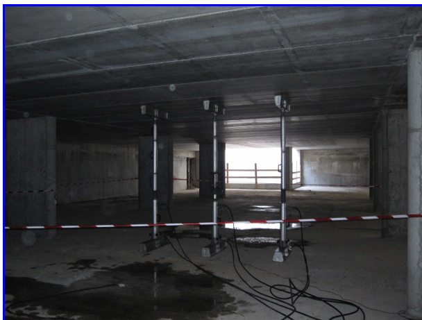
Foto 1: Martinetti oleodinamici utilizzati per l'applicazione del carico
