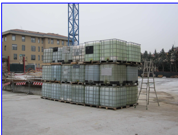
Foto 5: 36 cassoni disposti su 2 file da 6 ciascuna in 3 stese (carico max)
