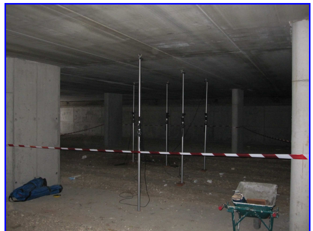
Foto 2: Sensori per rilevare le deformazioni in tempo reale
