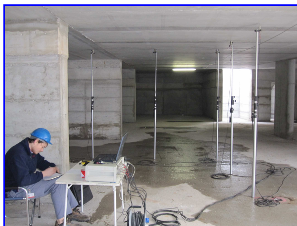
Foto 6: Sensori per rilevare le deformazioni in tempo reale
