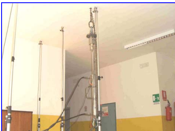
Foto 9: Martinetto oleodinamico utilizzato per l'applicazione del carico
