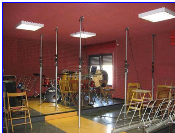
Foto 4: Sensori per rilevare i cedimenti in tempo reale
