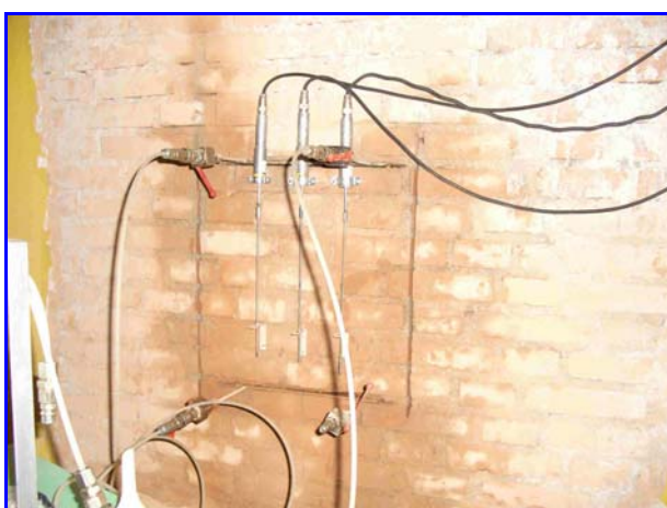
Foto 17: Rilievo tensione rottura
