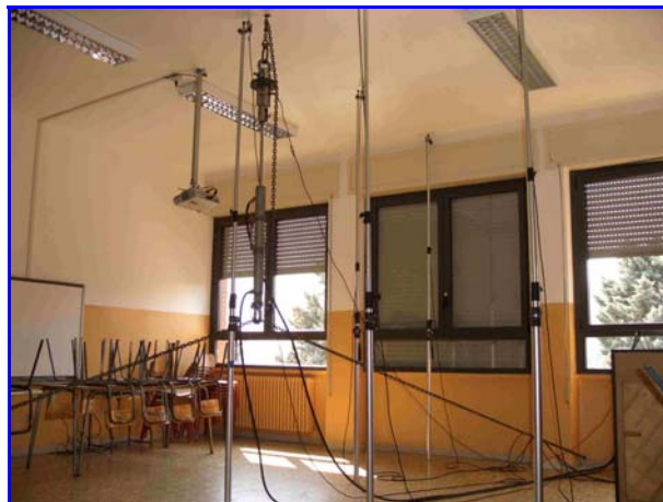
Foto 12: Sensori per rilevare i cedimenti in tempo reale
