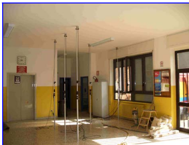
Foto 8: Sensori per rilevare i cedimenti in tempo reale
