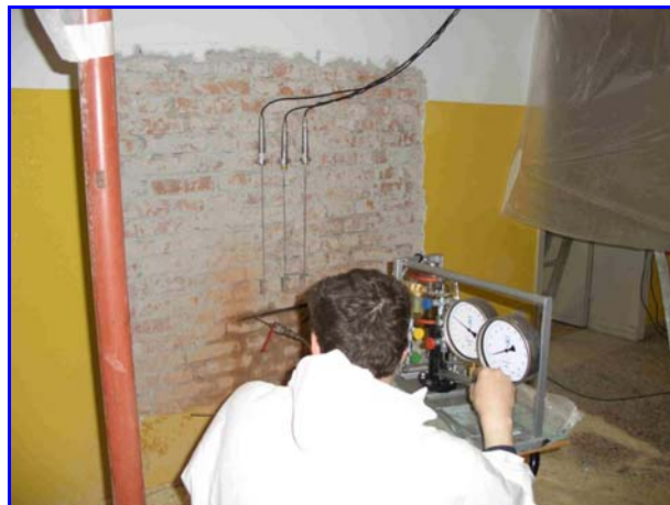
Foto 16: Rilievo tensione esistente
