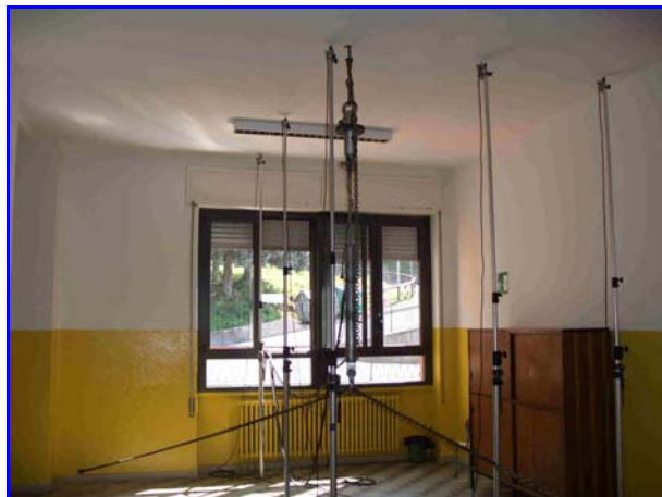
Foto 10: Sensori per rilevare i cedimenti in tempo reale
