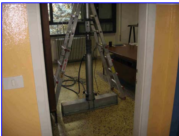
Foto 5: Martinetto oleodinamico utilizzato per l'applicazione del carico
