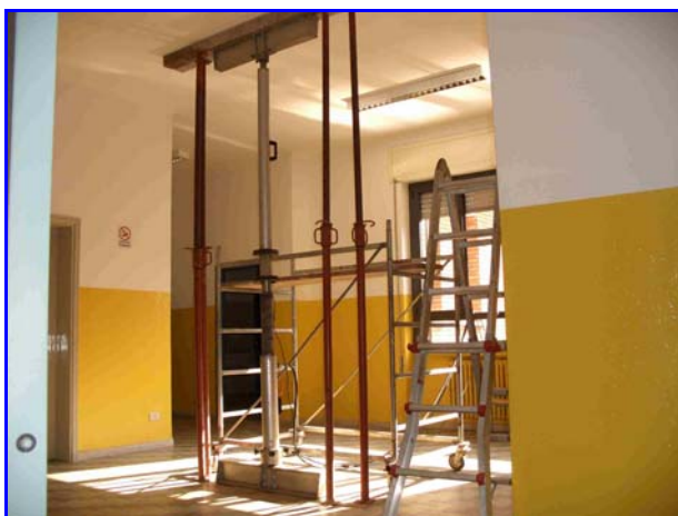
Foto 7: Martinetto oleodinamico utilizzato per l'applicazione del carico
