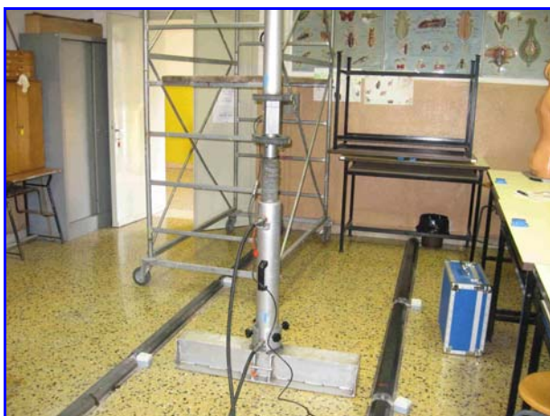
Foto 3: Martinetto oleodinamico utilizzato per l'applicazione del carico
