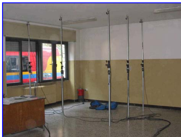
Foto 6: Sensori per rilevare i cedimenti in tempo reale
