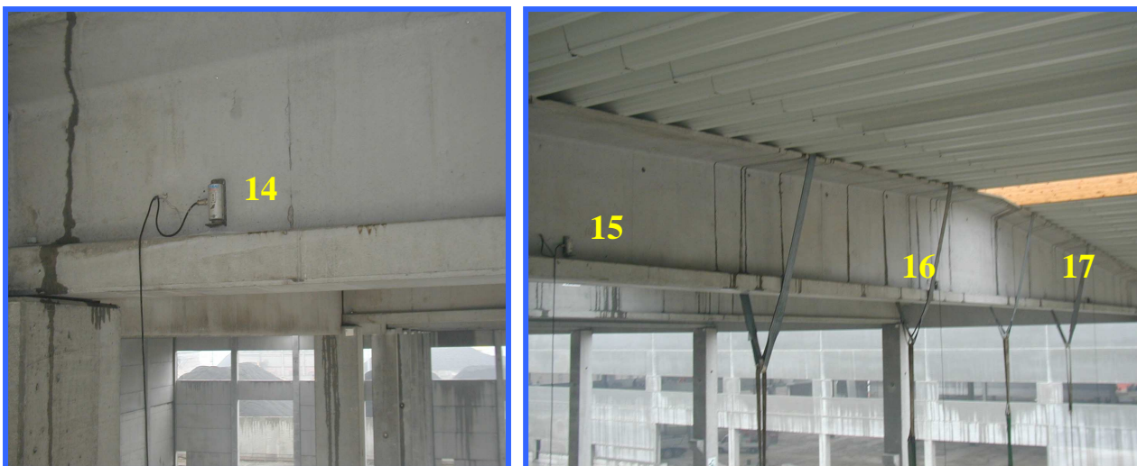
disposizione sensori inclinometrici
