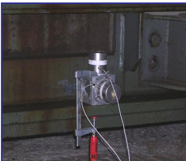
Foto 3 Coppia accelerometri ch1,2
