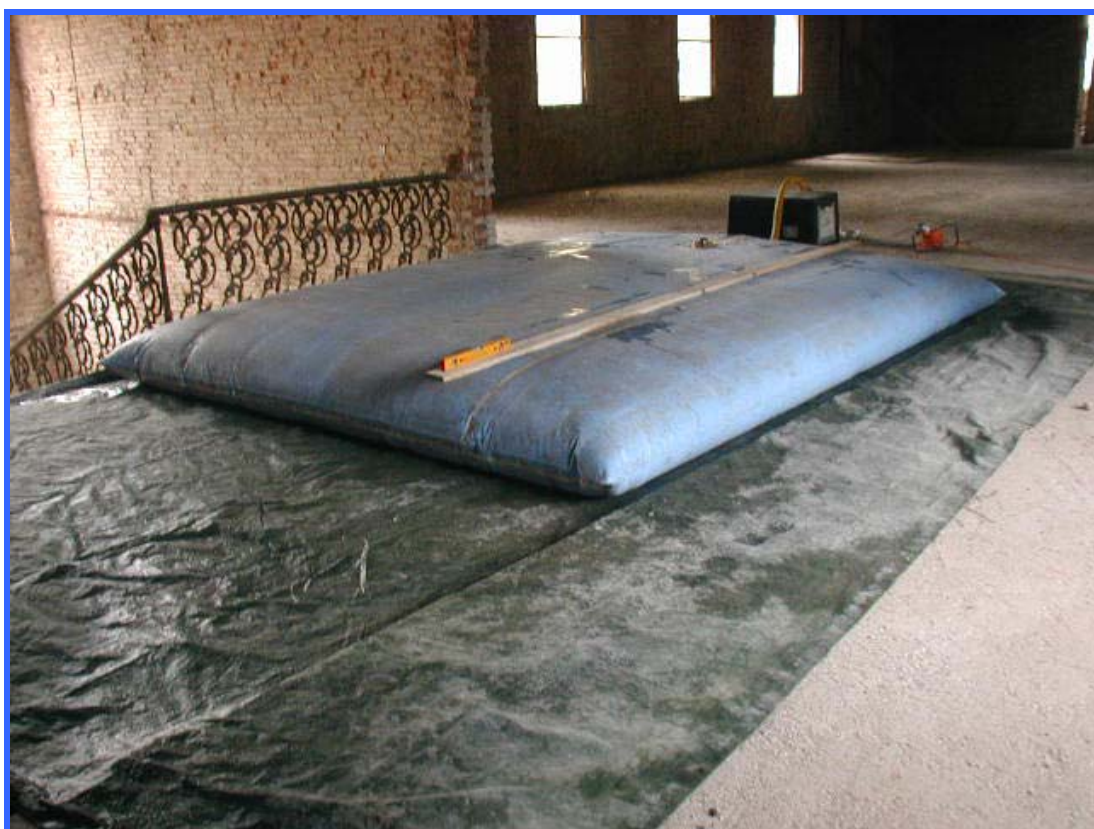
posizionamento serbatoio – carico massimo
