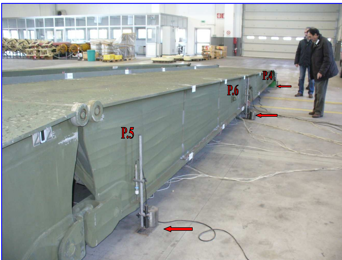
Vista generale moncione 4 - schema statico con due appoggi
