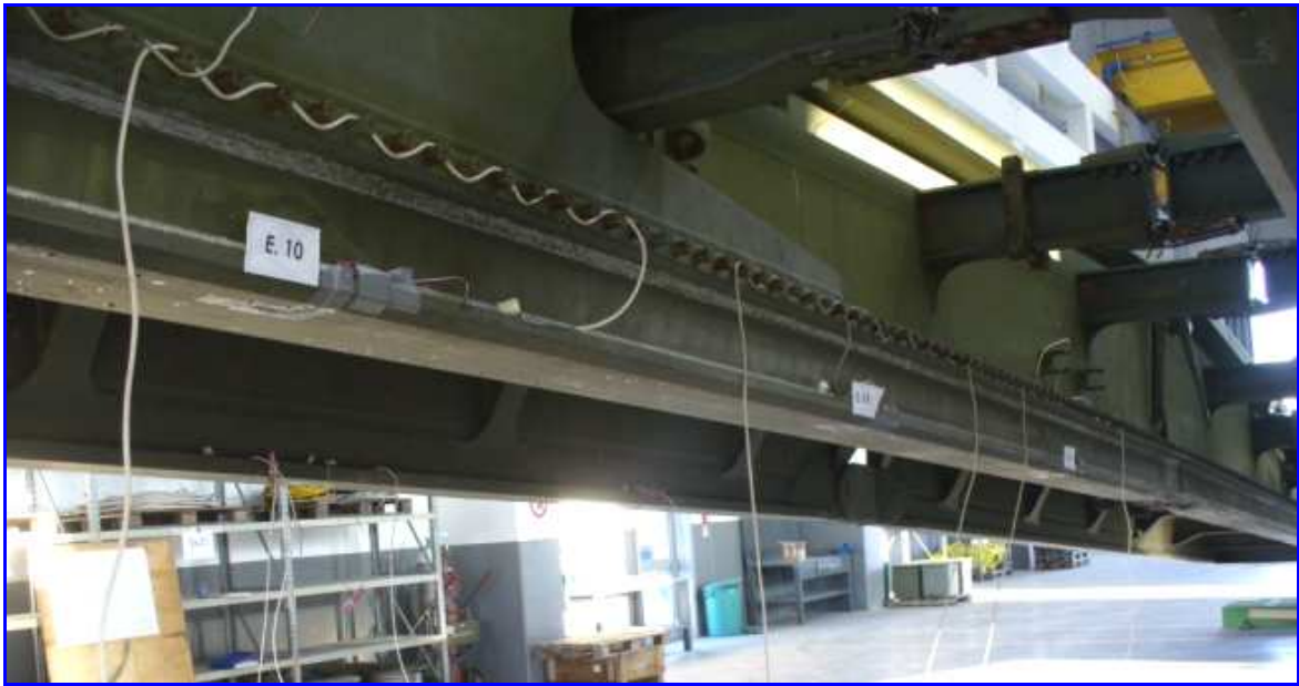
Estensimetri sulla trave interna
