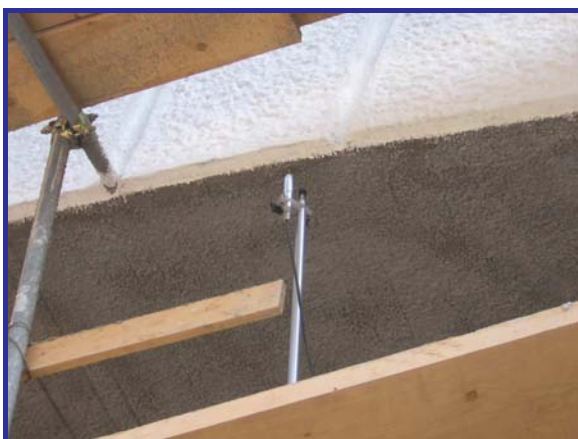
Trasduttore su bordo VI campata
