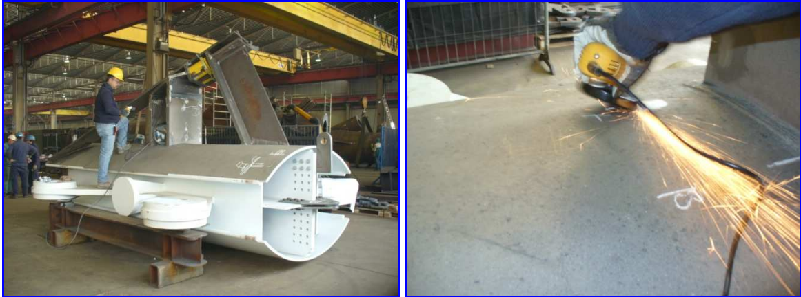
Fasi di preparazione delle superfici di incollaggio
