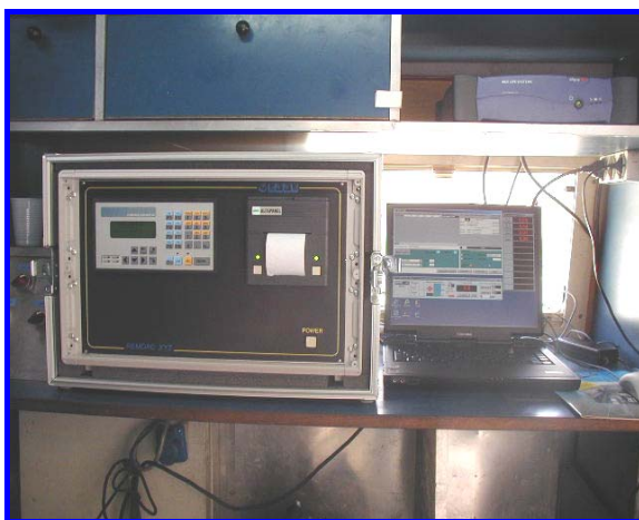
Foto 1: acquirente GS 04interfacciato con P.C., software di elaborazione
