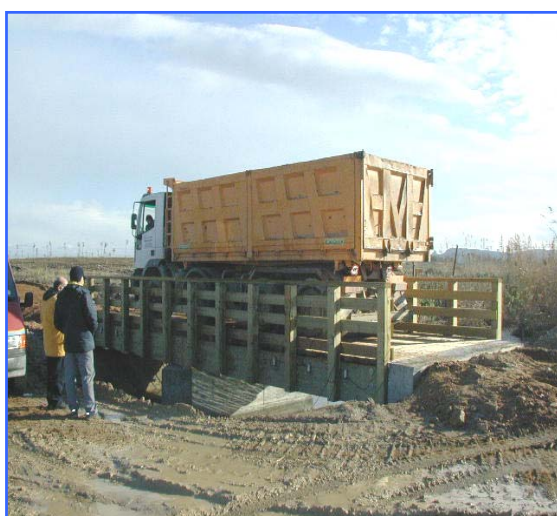
Foto 9 : fase di carico max
