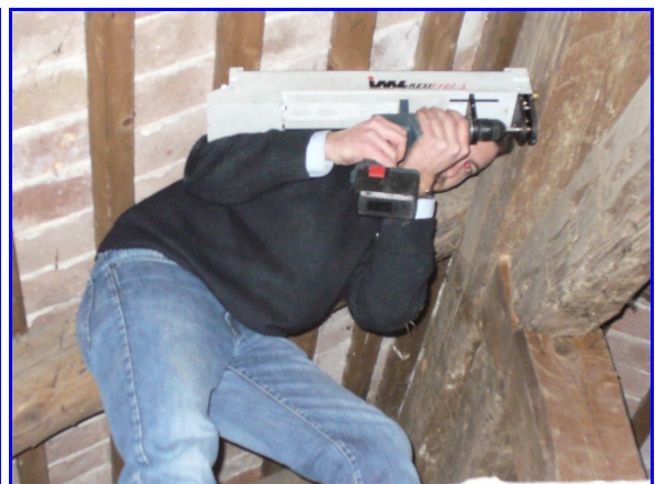
Fasi di indagine sulle travi principali
