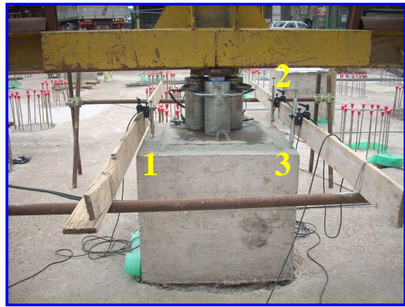
Particolare sensori e martinetti
