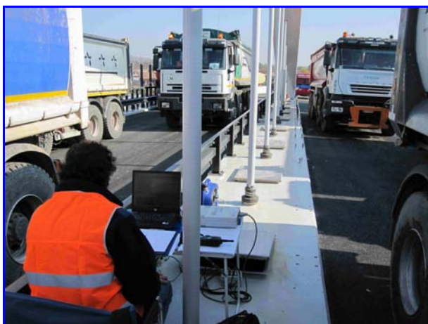
Foto 7: Postazione di acquisizione sensori in mezzeria
