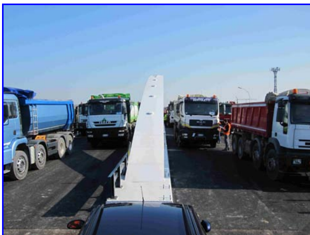
Fig. 6: Prima configurazione di carico
