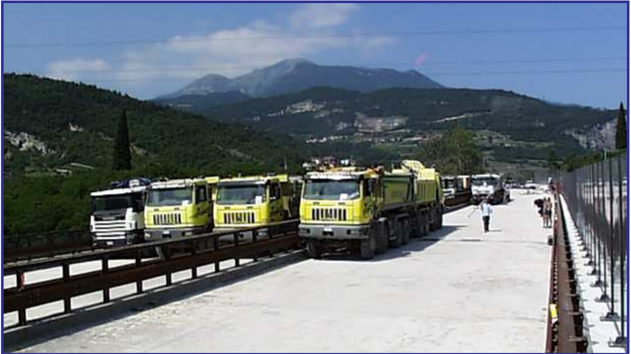
Ciclo C 3 “fase D” momento massimo su pila 5
