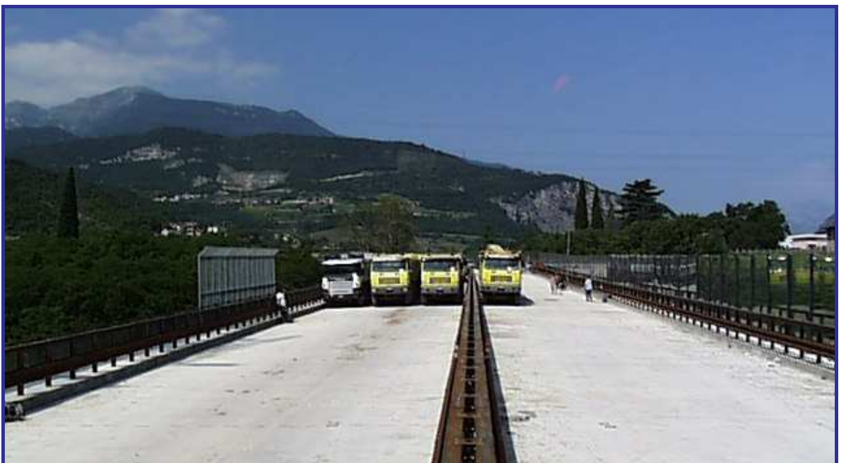
Ciclo C 3 “fase E” momento massimo 2 a campata
