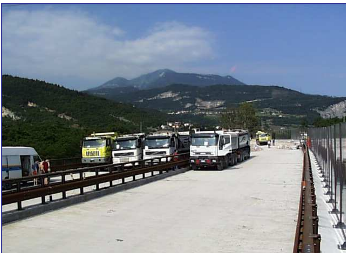
Ciclo C 2 “fase D” momento massimo 1 a campata
