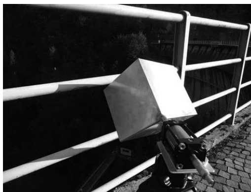
Figura 2 - Foto del corner reflector usato per la sperimentazione
