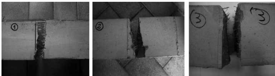
Figura 5 : Particolare provini con dettaglio della distribuzione delle fibre nella sezione di rottura
