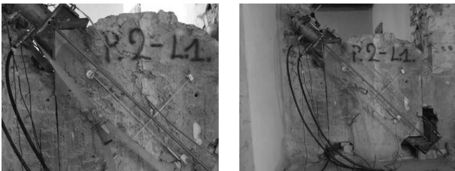
Figura 14 : Il pannello strumentato durante la prova
