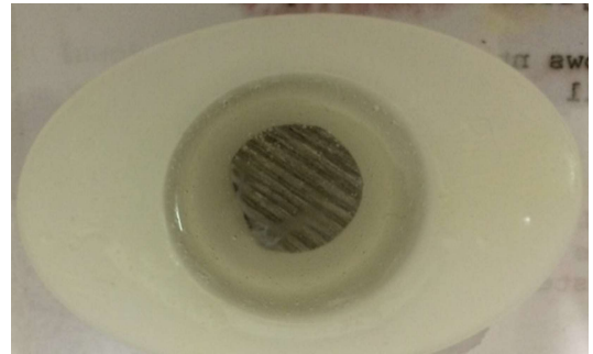
Figura 4: Campione di acciaio inglobato in resina
