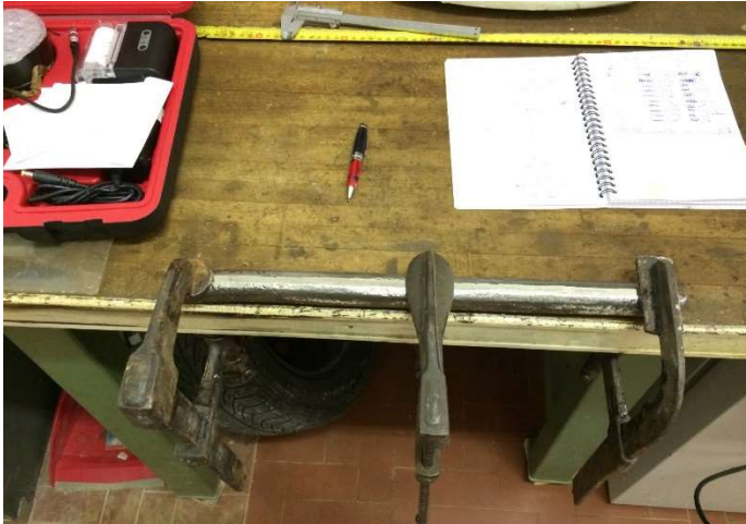
Figura 3: ancoraggio fallace di provino a tavolo preparazione ferri
