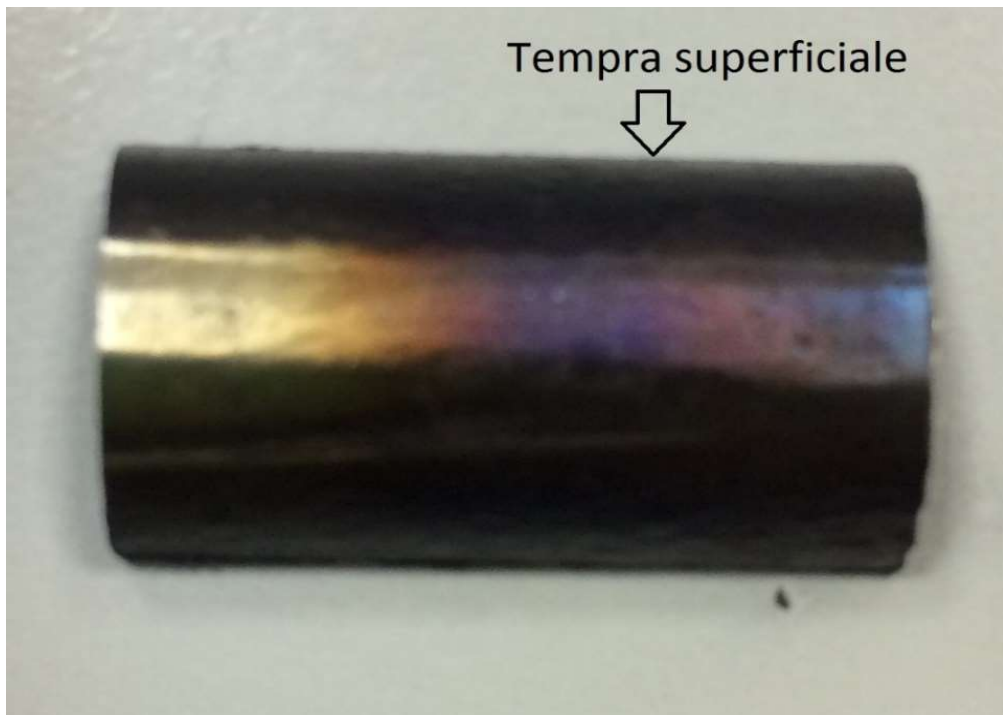
Figura 16: campione levigato con eccessiva veemenza, si noti il cambiamento di colore della superficie che indica una tempra superficiale.
