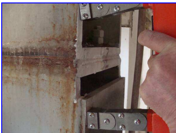
Controllo magnetoscopico con giogo
