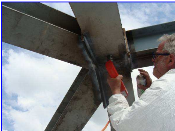
Controllo magnetoscopico sul colmo
