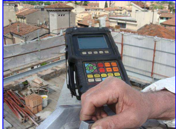
Controllo ad ultrasuoni con sonda angolata
