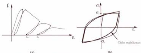
Fig. 2.48 Esempi di legami costitutivi del comportamento anelastico ciclico di: (a) calcestruzzo; (b) acciaio
