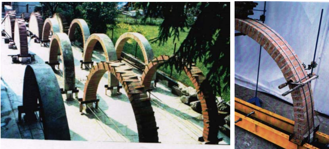
Figura 7. Arco armato: Modelli di archi in muratura predisposti per prove a scala reale
