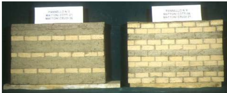
Fig. 11: Campioni con mattoni cotti e di terra cruda
