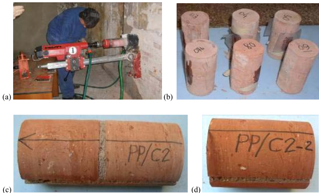
Fig. 5: Estrazione di carote di differente geometria dalla muratura (a) macchina carotatrice a corona diamantata, (b) cilindro di solo mattone, (c) con giunto di malta trasversale e (d) con giunto di malta longitudinale lungo il diametro
