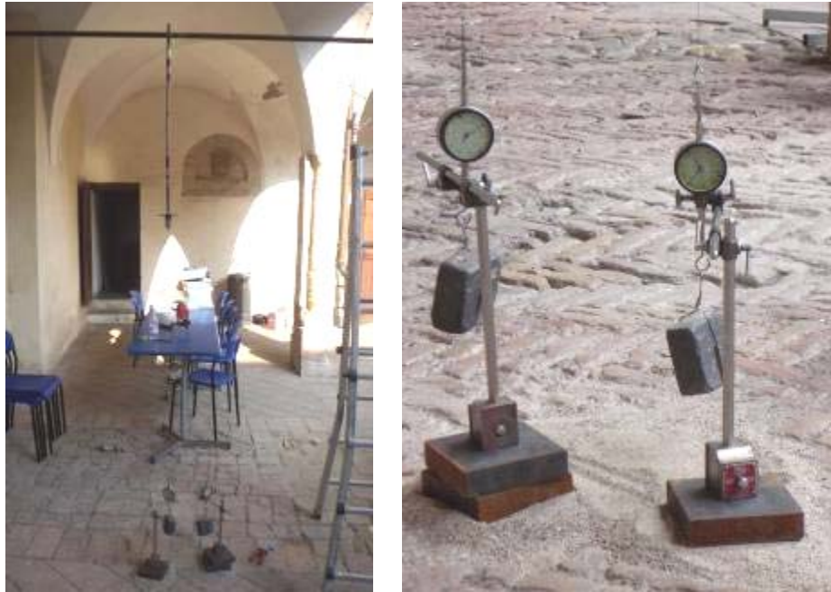
Fig. 21: Vista della prova di carico per determinare il tiro della catena
