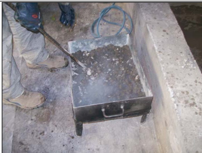
essiccamento campione di cls per determinazione rapp. a/c
