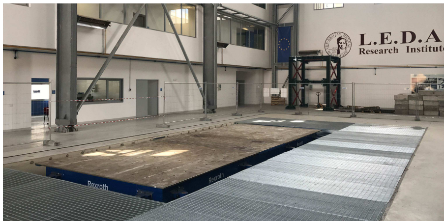
Figura 3. Tavole vibranti del L.E.D.A. nella configurazione connessa (tavola a 6 GdL 10 m × 4 m).
