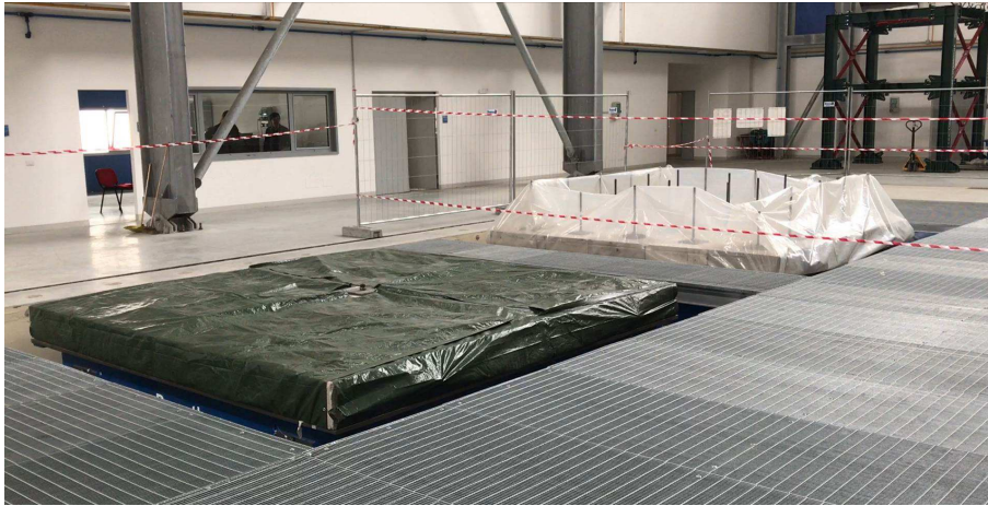
Figura 5. Vista delle due tavole vibranti durante le prove di sincronizzazione.
