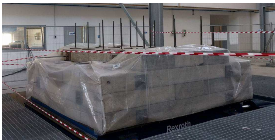
Figura 4. Vista del carico rigido da 40 t.
