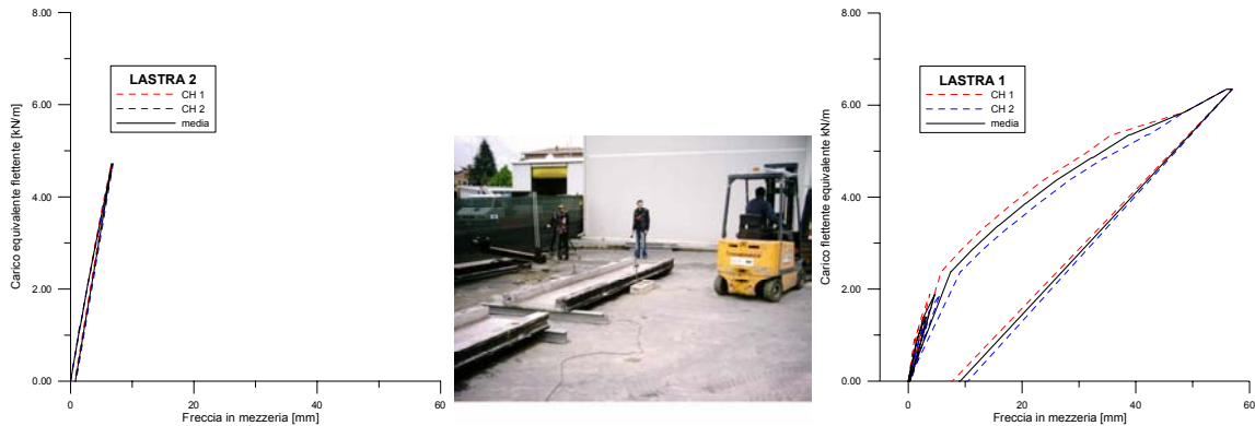
Figura 36. Prova di carico su coppelle precomprese danneggiate da incendio: a sinistra coppella integra a destra coppella danneggiata [foto dell'Autore].
