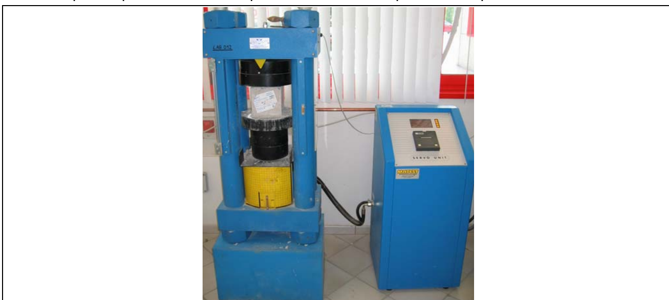
FOTO 4: pressa per l'esecuzione di prove di rottura a compressione di provini di cls
