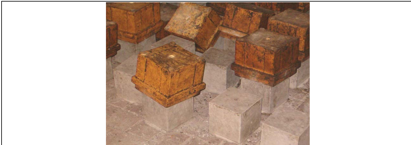
FOTO 3: verifica delle dimensioni di un provino cubico di conglomerato cementizio
