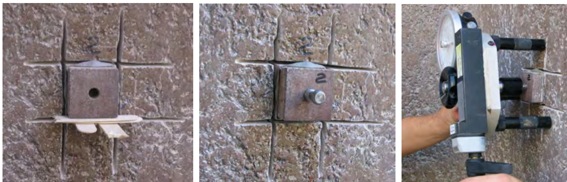
Figura 15: Fasi successive della prova di strappo in sito
