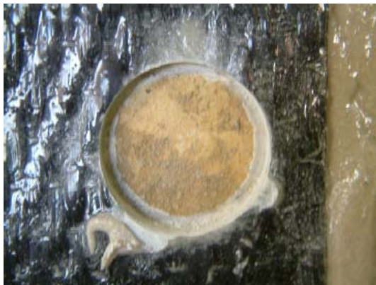
Figura 21: Corretto meccanismo di rottura.
