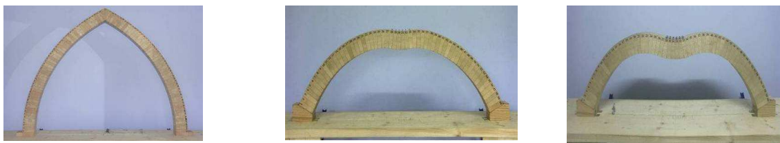
Figure 7, 8, 9: arco a sesto acuto, arco con modesta depressione e arco con accentuata depressione.
