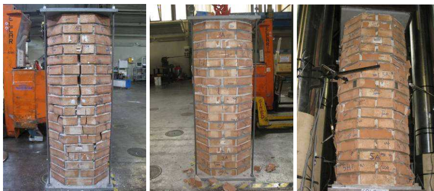
Figura 70, 71 e 72: immagini dei provini dopo le prove: COLONNA 1, 3 e 5.
