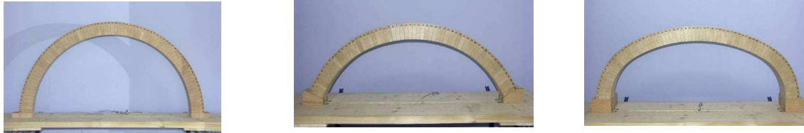
Figure 4, 5, 6: arco a tutto sesto, arco circolare ribassato e arco policentrico.
