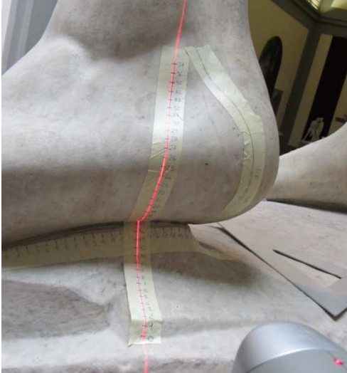
Figura 18: Tracciamento di una sezione verticale mediante livello laser
