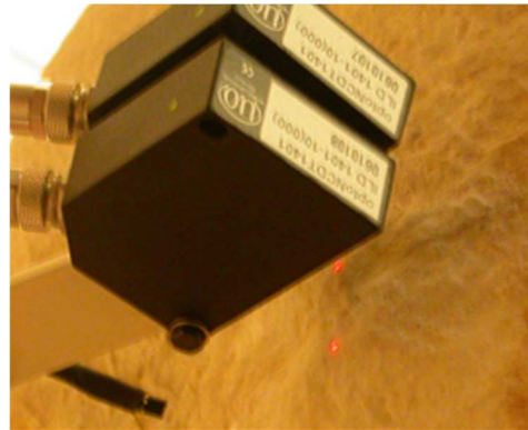
Figura 10: coppia di sensori per il monitoraggio di spostamenti relativi
