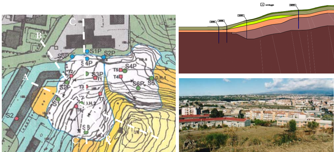
Figura 13. Frana di Monte Po. Planimetria, modello geotecnico del terreno e veduta della scuola elementare e dell'edificio dell'Istituto Autonomo Case Popolari, minacciati dalla frana.
